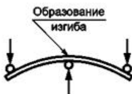
Рисунок 18 - Пример образовавшегося изгиба у образца
