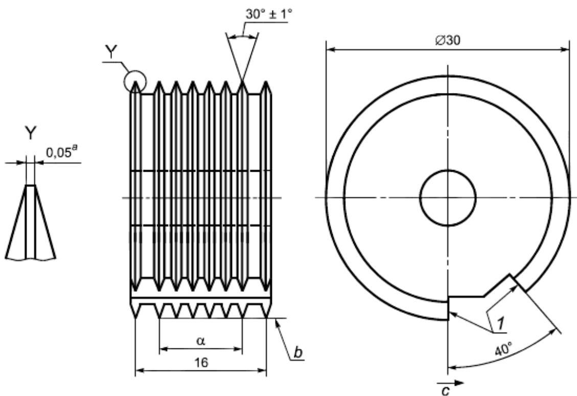
*a* - снова заточить при износе режущей кромки на 0,1 мм;
